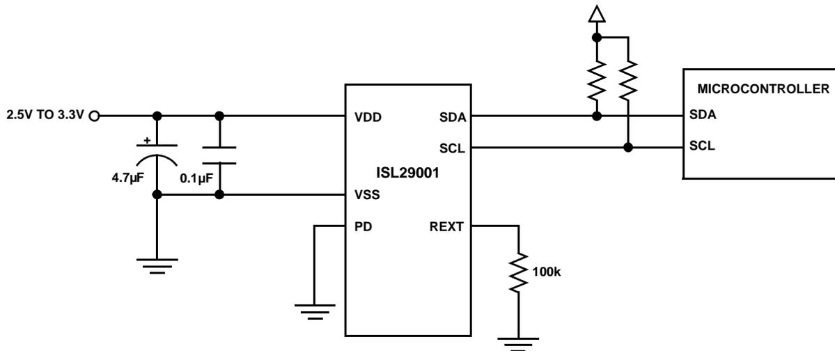
FIGURE 14. TYPICAL CIRCUIT
