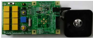
図 2 ML610Q304 音声アプリケーションボード スタンドアロン時の構成
